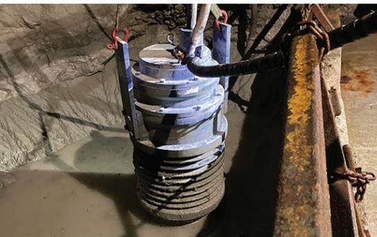
Pompe à boue submersible GPM-Eliminator
