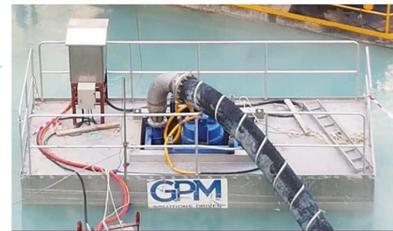
Pompe sur barge à arbre submersible GPM-Eliminator
