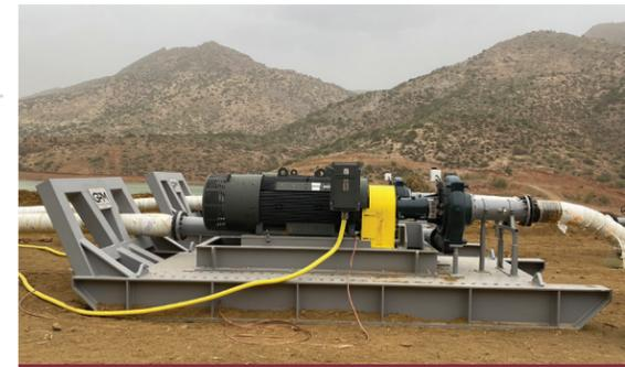
Pompe de gavage hydraulique à plateforme pour broyeur
