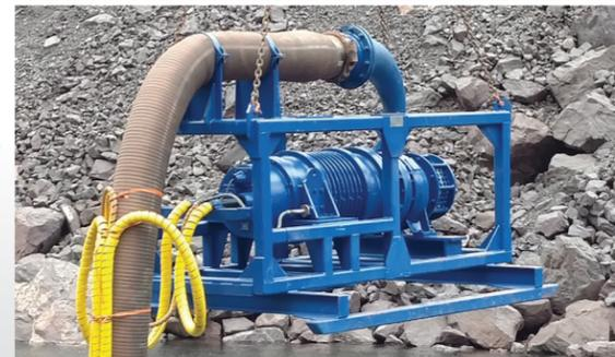
Bomba sumergible de alta carga de GPM
