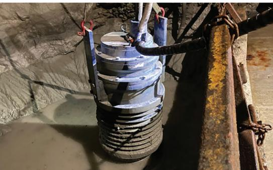
Bomba sumergible de lodo de GPM-Eliminator
