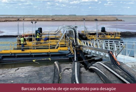
Barcaza de bomba de eje extendido para desagüe
