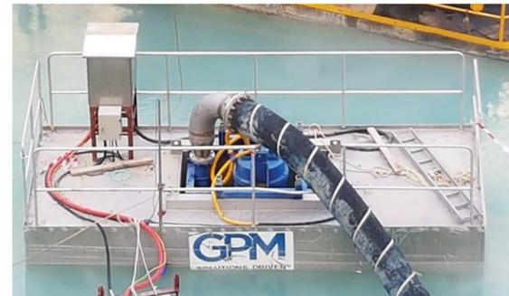
Barcaza de bomba sumergible de GPM-Eliminator
