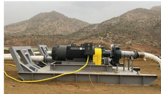
Unidad de bombeo auxiliar para agua de Molino montada en patín
